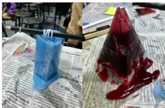
ภาพกิจกรรมที่ 9 การเทพาราฟินลงในแม่พิมพ์ที่นักเรียนได้สร้างขึ้นพบว่า มีรอยแตกร้าวที่ด้านล่าง
