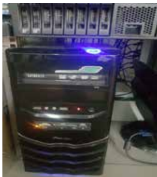
ภาพที่ 4.1 เครื่องคอมพิวเตอร์ส่วนบุคคลที่ติดตั้งระบบโทรศัพท์ IP-PBX ด้วย open source
