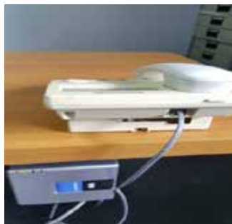
ภาพที่ 4.6 การเชื่อมต่อโทรศัพท์แบบอนาล็อกเข้ากับระบบ VOIP
